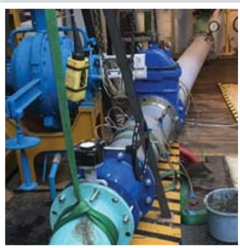
DN300 tolózár hidraulikai vizsgálata
